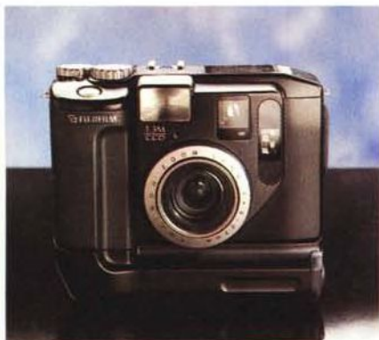
L'Extension Unit mette a disposizione una porta SCSI e consente riprese in rapida sequenza, a 4.5 fotogrammi al secondo (vedi testo).
